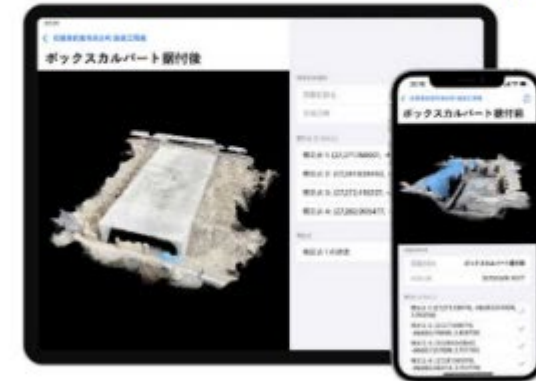
ボックスカルバート計測データ
