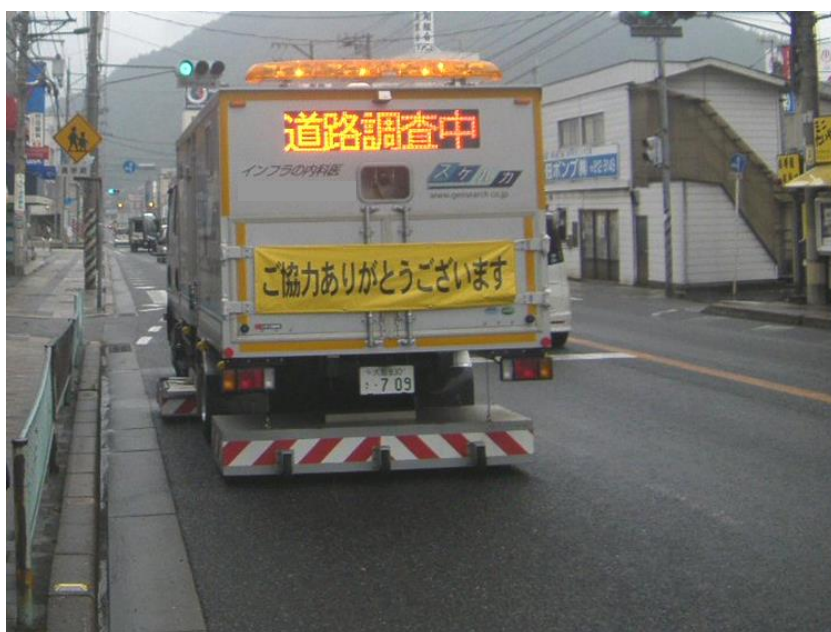
路面下空洞調査車 (三次元多配列レーダー)
