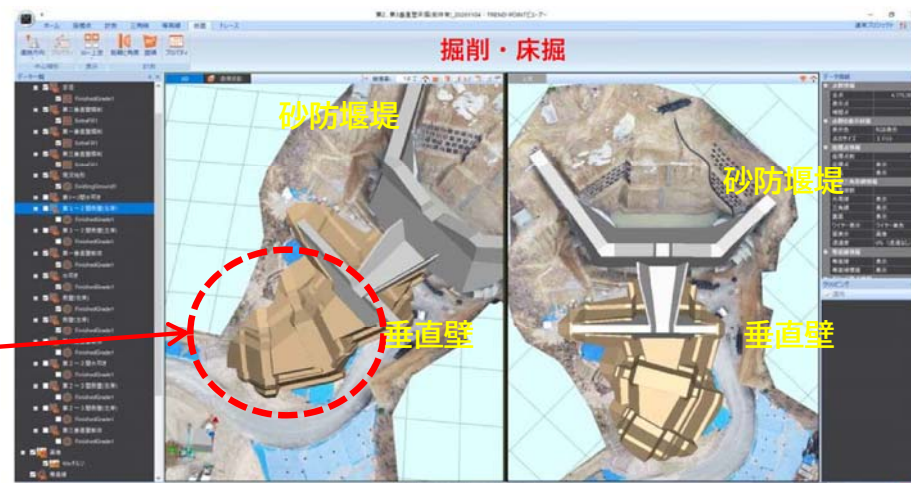
UAV測量にて計測した3次元現況データに設計データを合体
