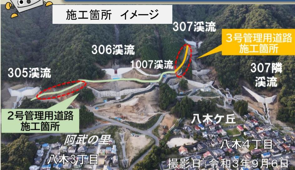
3号管理用道路は、擁壁工事が完成し、縁石、コンクリート舗装工事を施工しています。
