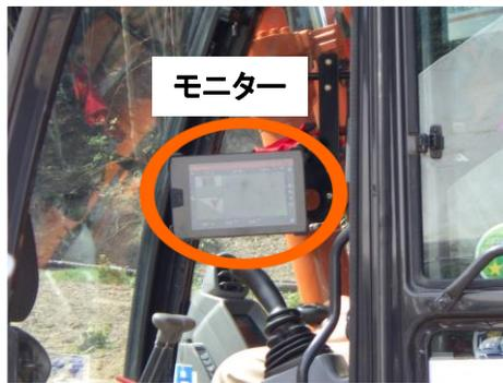
半自動制御されたICT建機を使って3次元設計データ通りに施工が可能となり、経験の浅いオペレータでも施工精度が向上します。
