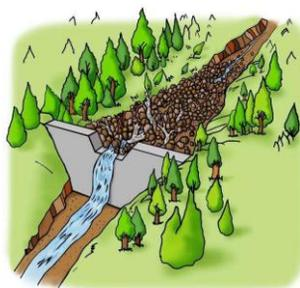
砂防ダムは土石流を捕捉することを目的としてつくられています。また、砂防ダムに土砂が堆積しても、上流側の勾配が緩くなり流速が落ちるため、川の侵食を防ぐなどの効果もあります。
