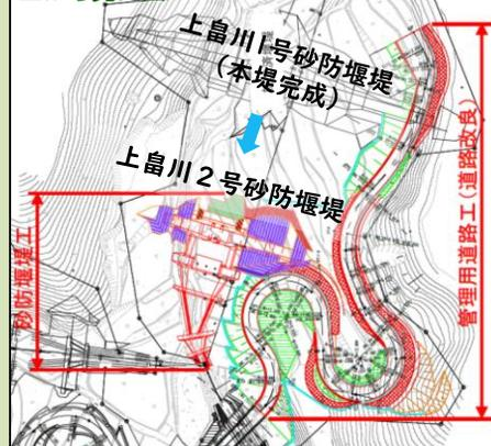
現在は伐採が完了し、砂防堰堤をつくるための測量作業を行っています。
