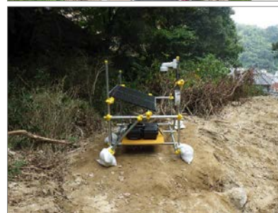
監視カメラ設置状況
