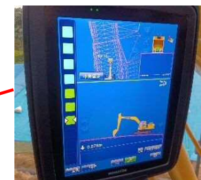
ICTバックホウ運転席内の マシンコントロール画面
