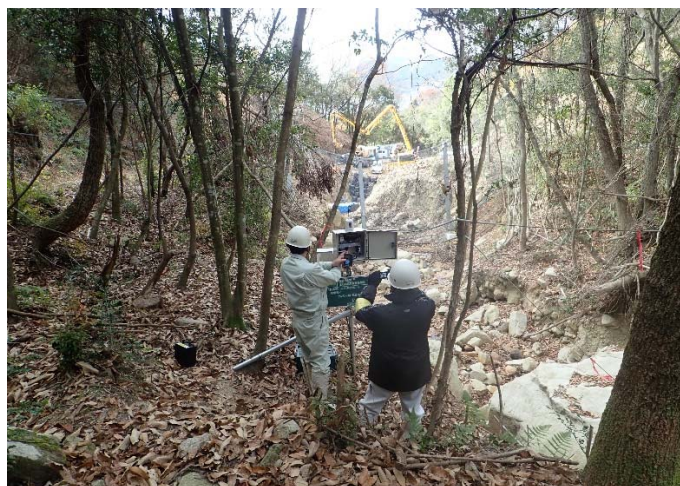
ワイヤーセンサーの点検状況
