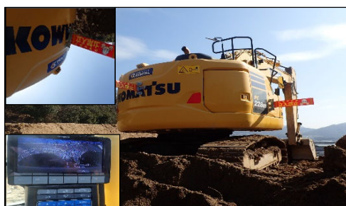
写真-14 後方カメラ搭載バックホウ
