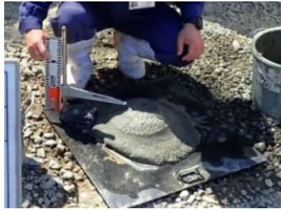
写真-6 入荷モルタルのスランブ測定
