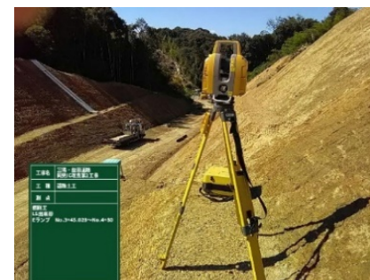
レーザースキャナによる出来形計測
