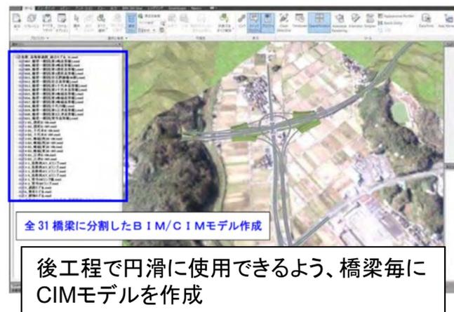
後工程で円滑に使用できるよう、橋梁毎にCIMモデルを作成
