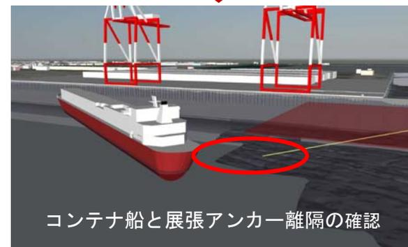
コンテナ船と展張アンカー離隔の確認
