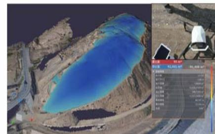
UAVによる掘削土量確認
