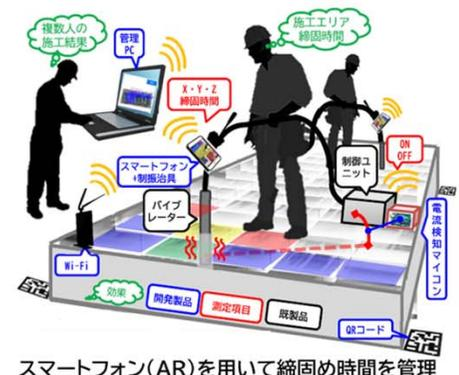
スマートフォン(AR)を用いて締固め時間を管理
