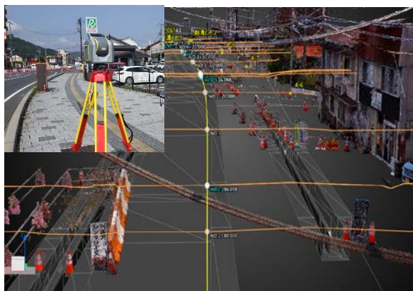
地上レーザースキャナーによる起工測量
