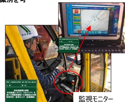
施工領域安全監視システム(3Dバリア)
