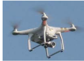
UAV(ドローン等)による3次元測量
