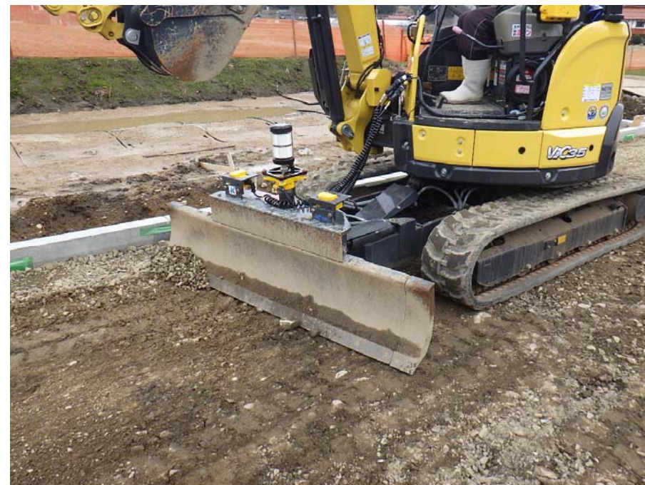
排土板制御システム流用(幅1.55m)
