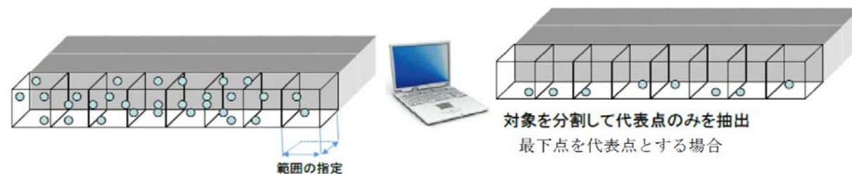
図 2-4 点群データの密度を均一にする方法 (例)
