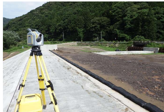
地上型レーザースキャナーを用いた出来形測量
