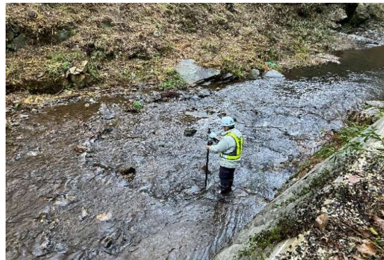
ICT擁壁工の3次元出来形測量
