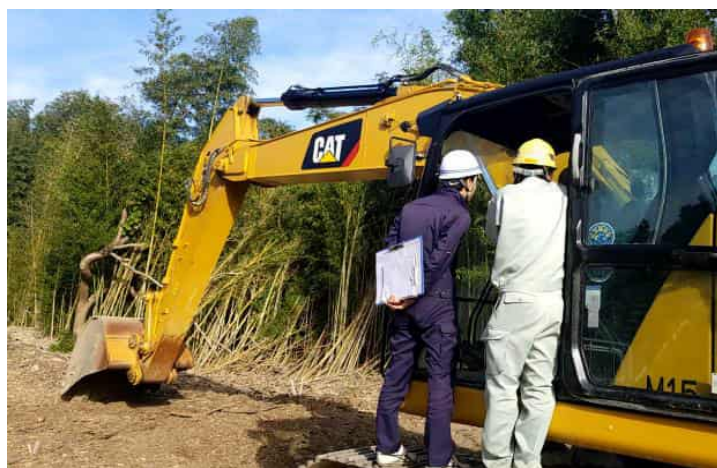
ICT建機施工用3次元設計データ設定状況
