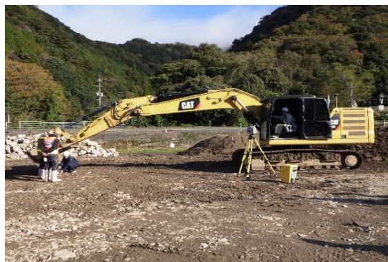
地上型レーザースキャナーを用いた出来形測量
