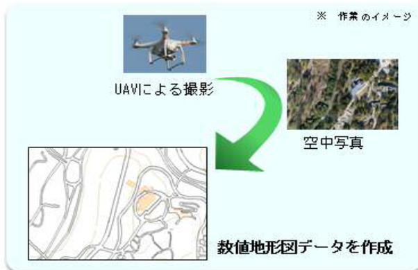
UAVを用いた空中写真測量
