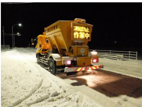
凍結防止剤散布作業
