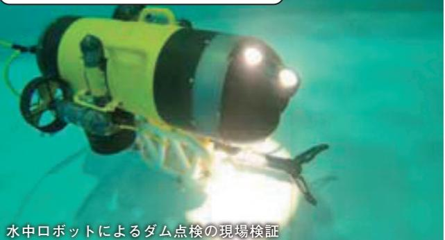
水中ロボットによるダム点検の現場検証
