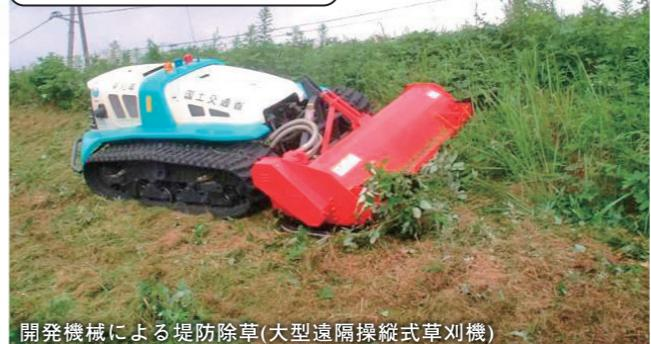
開発機械による堤防除草(大型遠隔操縦式草刈機)
