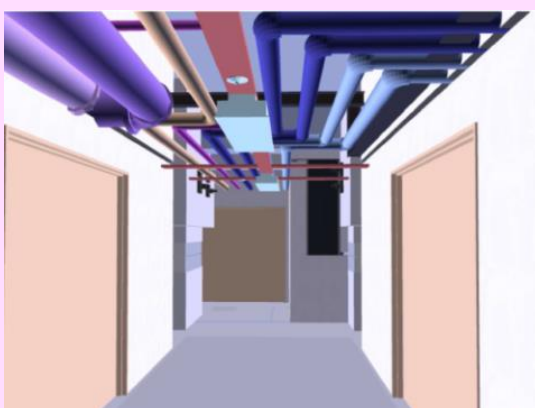
施工BIM 配管と壁の干渉チェック
