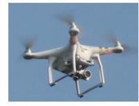
UAV(ドローン等)による3次元測量
