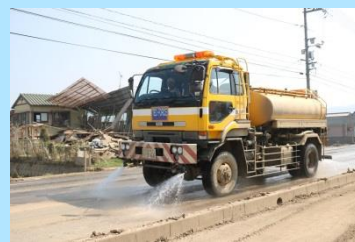
「散水車」による道路啓開作業補助
