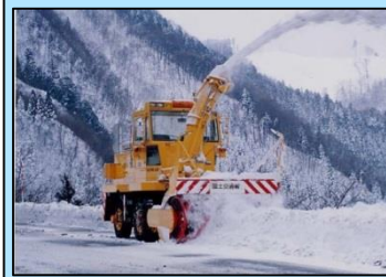
「ロータリー除雪車」による除雪作業
