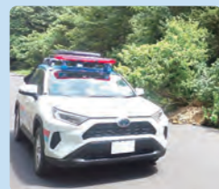
衛星を用いて道路等の被災状況を伝送する Car-SAT
