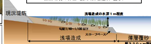
自然環境の保全・復元(浅場造成・覆砂)
