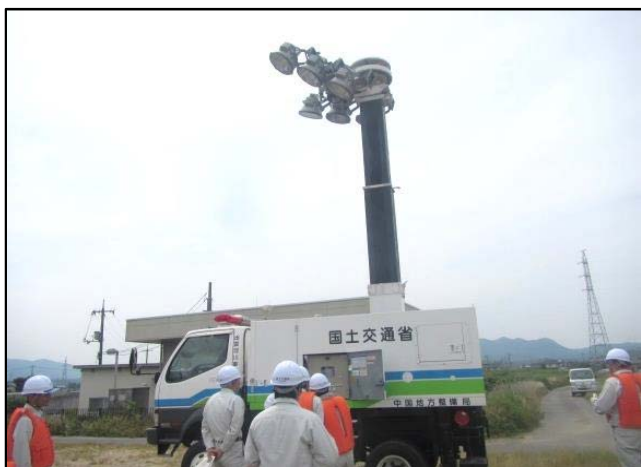
照明車（ポール式） ・照明ポール延伸作業中
