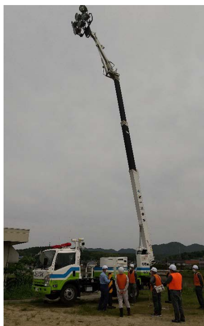
照明車（ポール式） ・照明ポール延伸作業中
