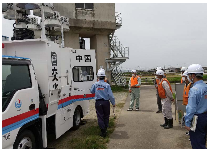
照明車（ポール式） ・照明ポール延伸作業中
