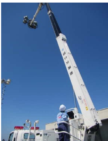
照明車 (ブーム式) 照明ブーム屈 伸作業中
