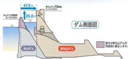
ダムのかさ上げによる治水機能の強化と水力発電の増強
