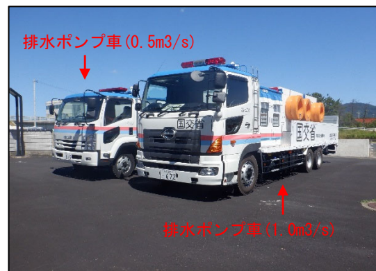
排水ポンプ車配備状況
