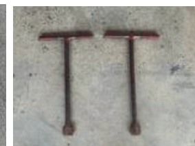
【吊り治具】 二次製品業者からリース
