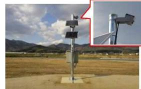
簡易型河川監視カメラの設置例
