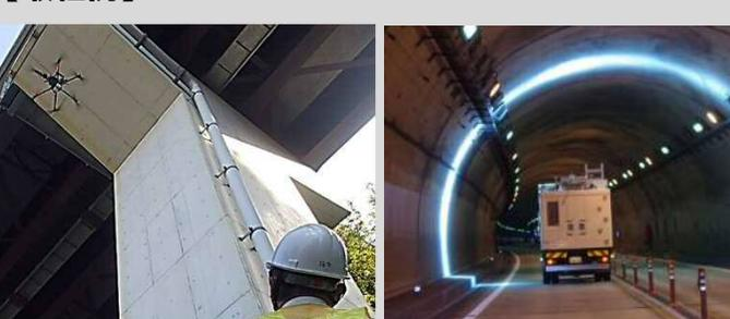
目視点検がしにくい場所も効率的に点検 通行止め等をせずに、車両に搭載したカメラでひび割れ等を把握
