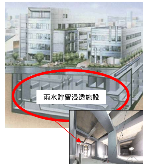
雨水貯留浸透施設の整備イメージ
