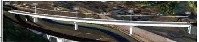
第3案モデル：鋼4径間連続合成細幅箱桁橋
