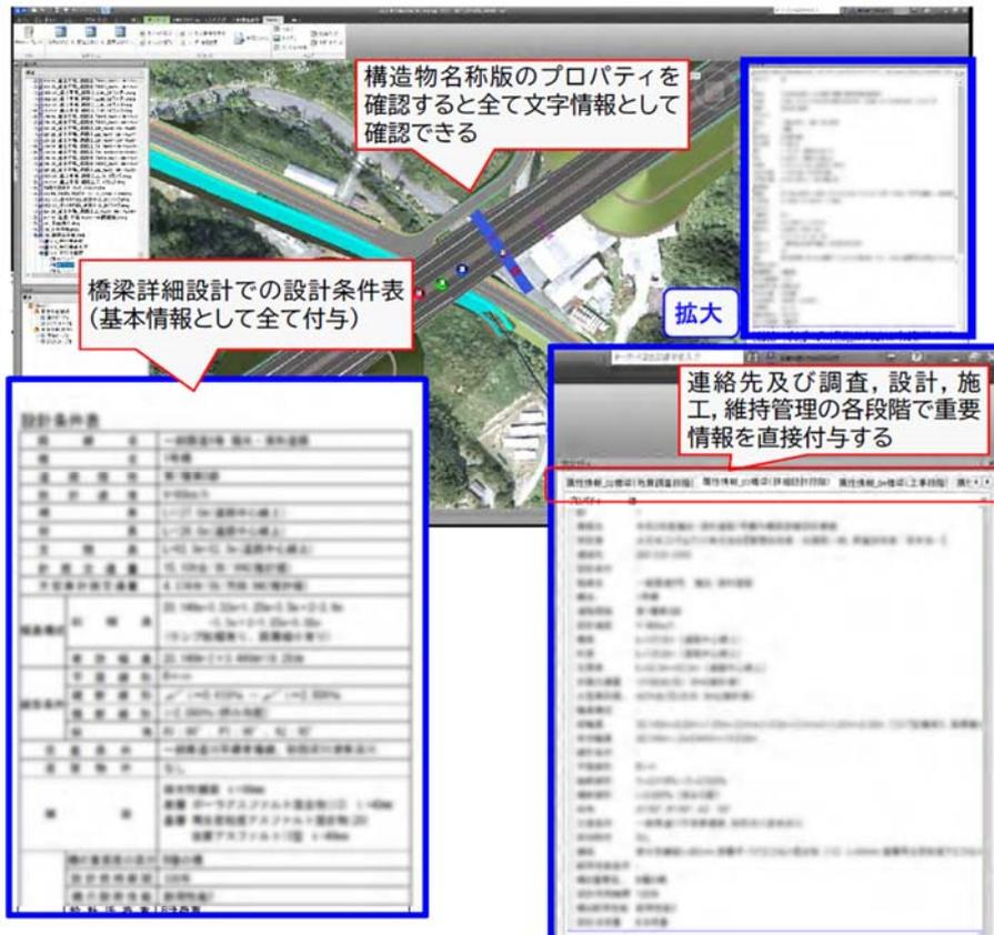
図 4.2.3-4 構造物名称版モデルを用いて重要情報を直接付与した事例
