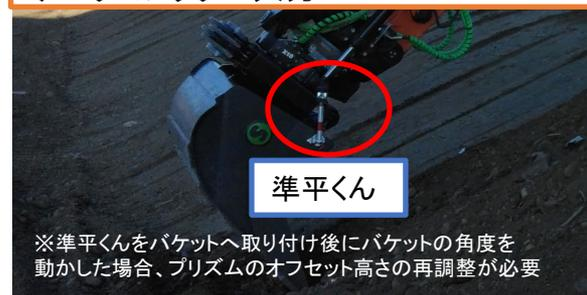
※準平くんをポケットへ取り付け後にポケットの角度を動かした場合、プリズムのオフセット高さの再調整が必要
