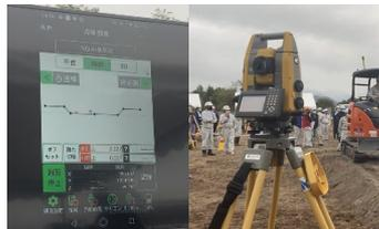
TS検査による水系設置
