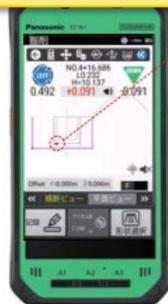
バケットを鉛直状態にして切り出し位置に合わせるため、2Dガイダンス画面でバケット角度を確認(角度表示が可能)
