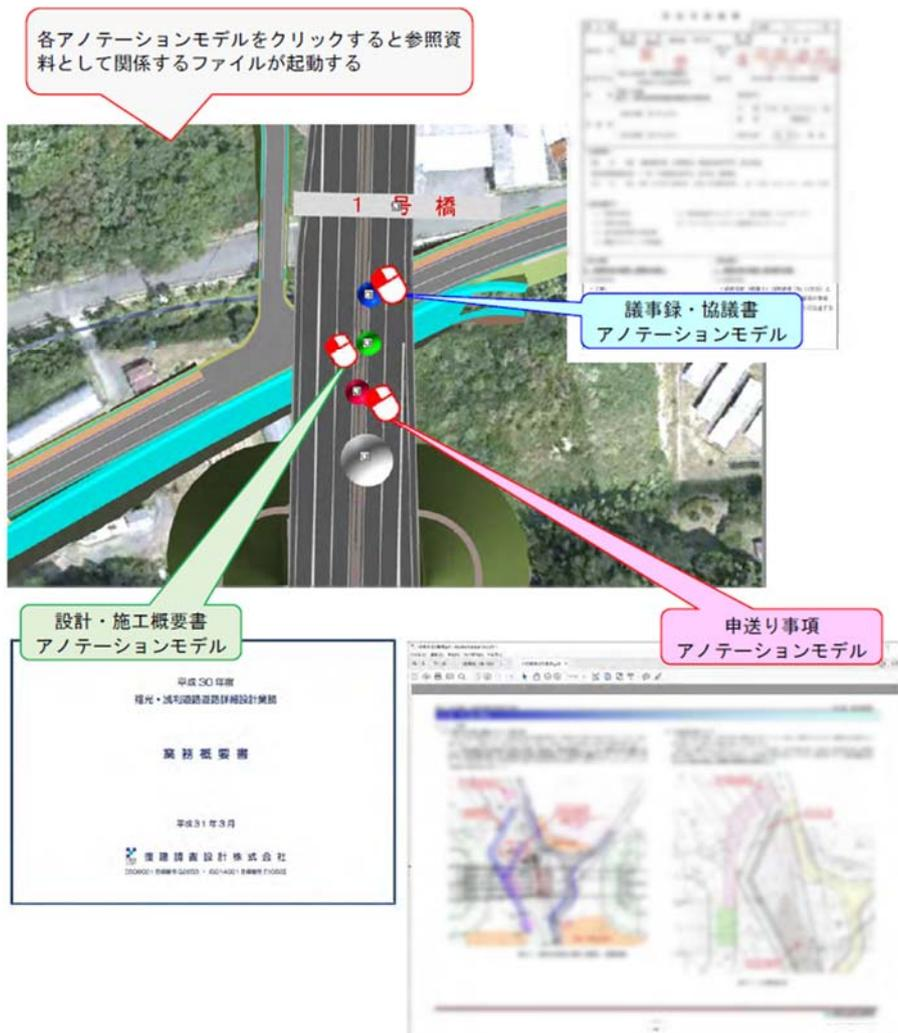
図 4.2.3-5 アノテーションモデルを用いたファイル参照の事例
