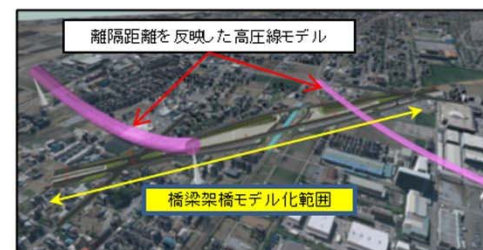
橋梁と架空線の離隔確認
