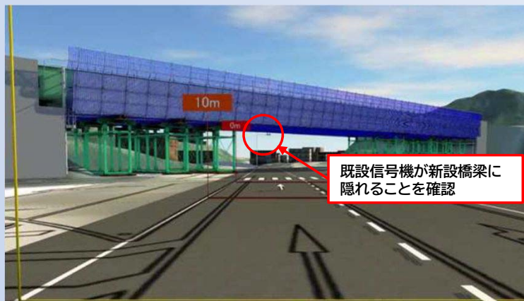
走行視点動画：既設信号機の視認性の確認
