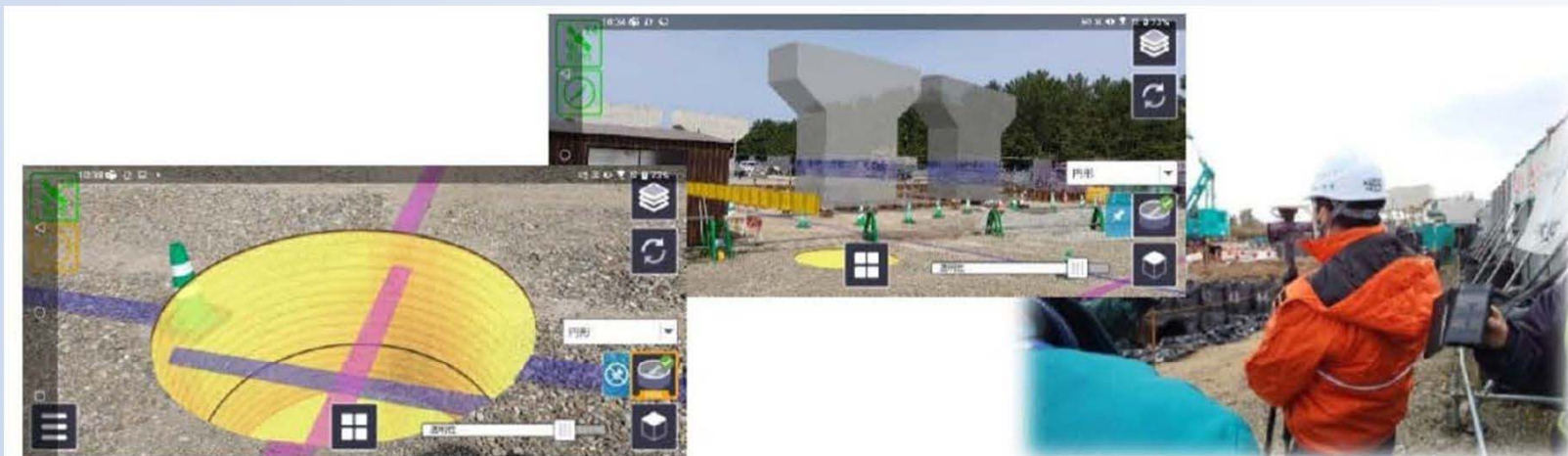
AR現地確認状況
