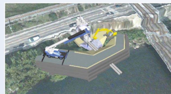
STEP6～7：ゲート工～仮設撤去工
