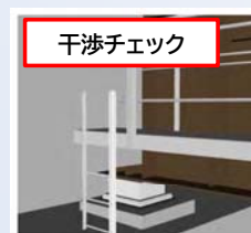
図3.4.1 桁端狭隘部の部材干渉確認(左:A1、右:P4)
