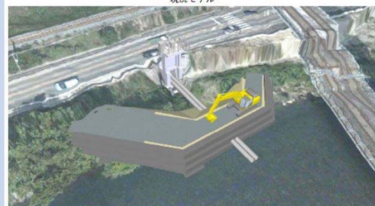
STEP1：仮設工施工尾時
