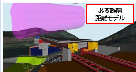
JR架線や高圧線との離隔距離確認
