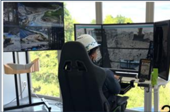
遠隔操縦機械による操作状況
