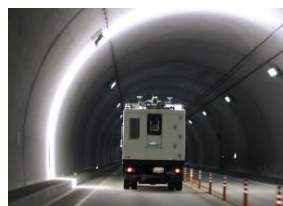
走行型画像計測による点検
