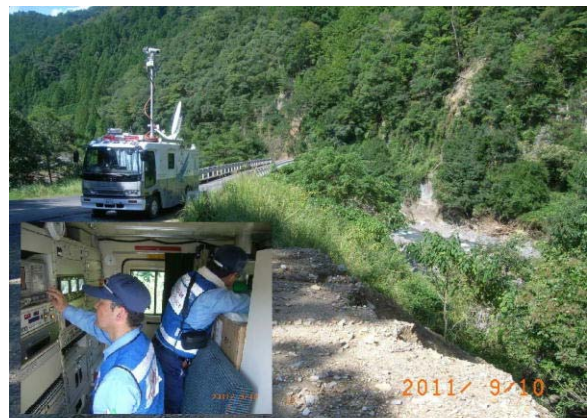
衛星通信車による土砂災害箇所監視状況
