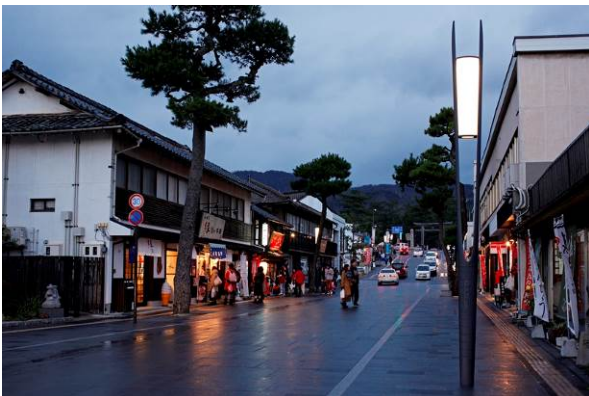
通りに植えられた松にちなみ松の葉をイメージさせる街路灯と、電線共同溝整備による架空線撤去によって開放感溢れる空間となった神門通りの夕暮れ。
