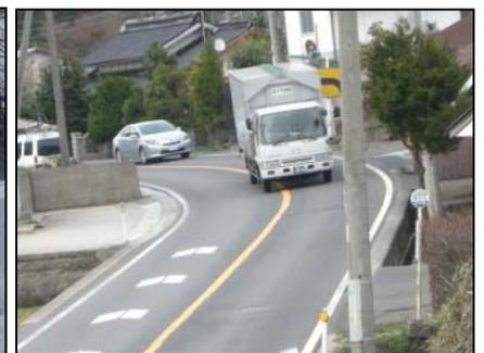
【写真④】線形不良による大型車のはみ出し状況
