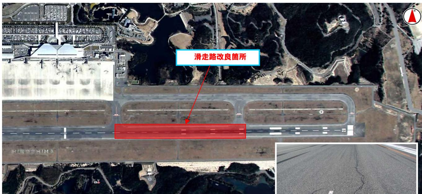
舗装表面の経年劣化によるひび割れの発生
