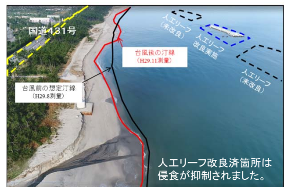
■人工リーフ改良の効果 (H29.10台風21号時の富益工区における汀線の経過状況)
