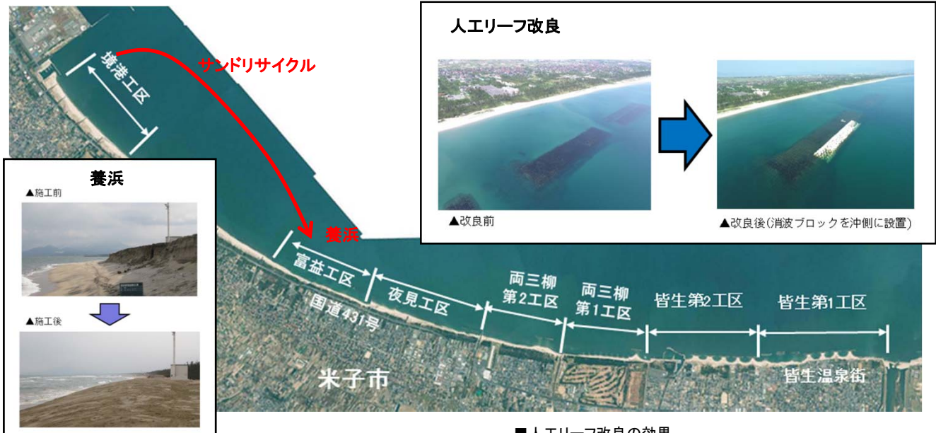
■人工リーフ改良の効果 (H29.10台風21号時の富益工区における汀線の経過状況)
