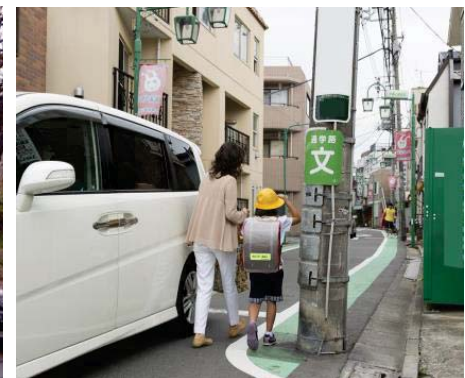
＜歩行の支障となる電柱の事例＞
