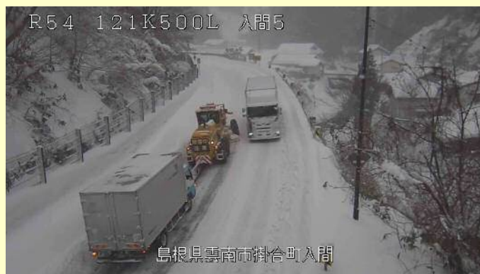
スタック車両の牽引 （島根県雲南市掛合町）
