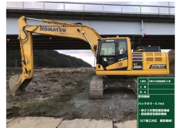
【インテリジェントマシンコントロール油圧ショベルによる施工状況】
