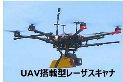
UAVレーザ機より取得したGNSS観測データ及びIMU観測データを用いて最適軌跡解析を行い、高精度の点群データを作成
